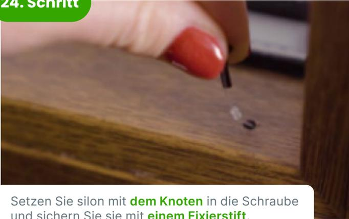
Setzen Sie silon mit **dem Knoten** in die Schraube und sichern Sie sie mit **einem Fixierstift**.
