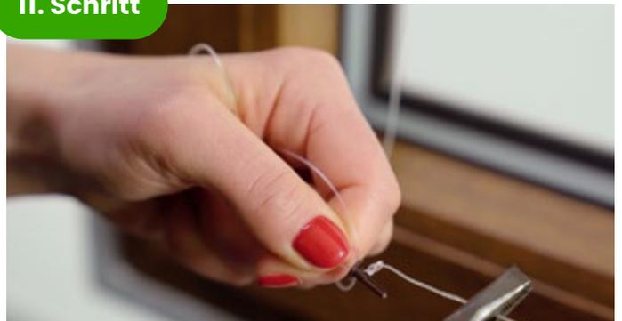
Ziehen Sie den Knoten an der Schnur fest und **kürzen Sie diese ca. 5 mm hinter dem Knoten**.
